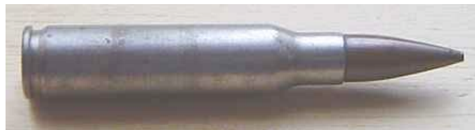
Cartouche de manipulation, étui nickelé, balle chemisé tombac (Cuivre et zinc)
